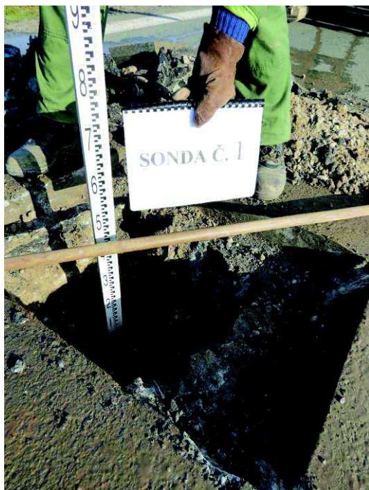
Sonda č.1 rozhraní konstrukčních vrstev
