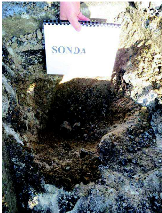
Sonda č.1 rozhraní konstrukčních vrstev
